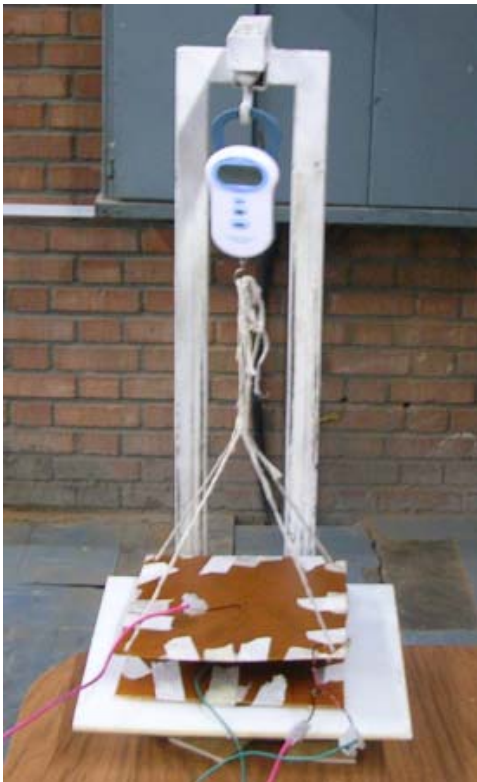
شکل ۸: اندازه‌گیری نیروی مغناطیسی بین دو سیم‌پیچ
