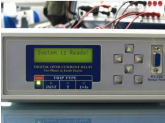
شکل (۱۳): شکل ظاهری رله دیجیتال ساخته‌شده
