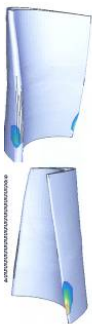
شکل (۲): محل های بحرانی بر روی پره ردیف اول GE-F5. این محاسبات براساس پارامتر لارسون - میلر انجام شده است [ ۵ ]
