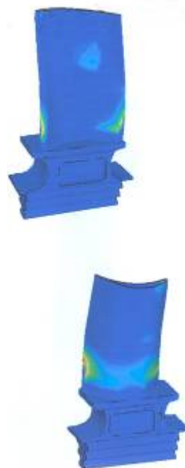
شکل (۱): توزیع سرعت خزش در قسمتهای مختلف پره توربین GE-F5 براساس محاسبات طراحی. الف) در سمت مقعر، ب) در سمت محدب پره. این توزیع نشاندهنده محل های بحرانی بر روی این پره از دیدگاه خزشی است.
