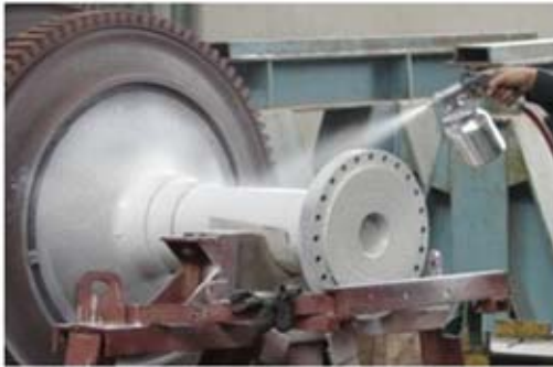
شکل ۷: پاشش محلول کربنات کلسیم
