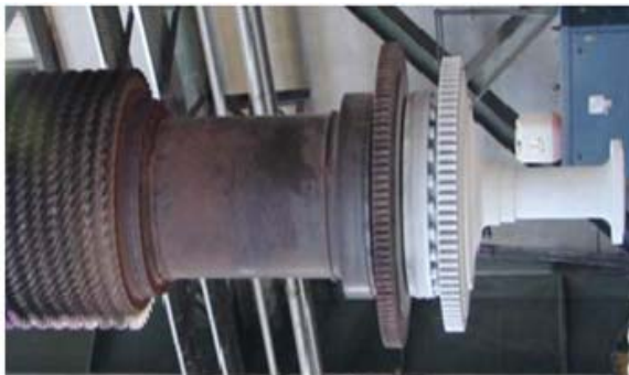
شکل ۸: نصب ترموکوپل و المنتها در منطقه عملیات حرارتی
