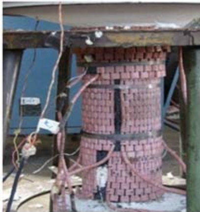
شکل ۸: نصب ترموکوپل و المنتها در منطقه عملیات حرارتی
