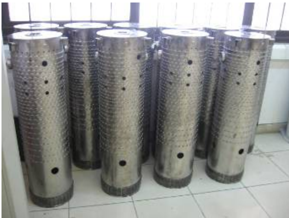
شکل ۱۱- تصویر یکدست لاینر فریم ۵ ساخته شده
