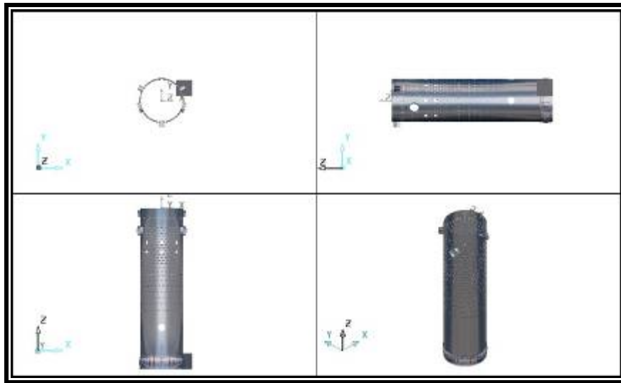
شکل ۴- مدل سه بعدی تهیه شده لاینر با استفاده از نرم افزار POWER SHAPE
